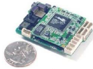
Fig. 5. Procerus Kestrel autopilot [17].
